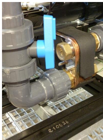
Sortie eau préchauffée de l'échangeur
